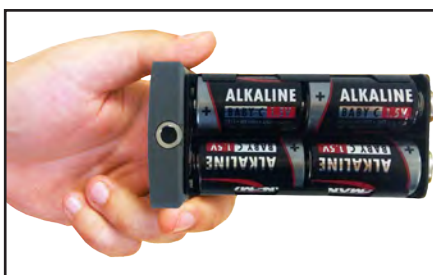
б) Вставить батареи в отсек, соблюдая полярность
