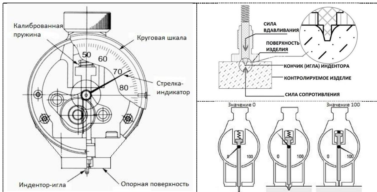
На получаемые результаты влияет форма индентора и прилагаемая к нему сила, поэтому между результатами, полученными при испытаниях с твердомером по шкале Шора тип А и твердомером по шкале Шора тип D, не может быть прямой зависимости.
