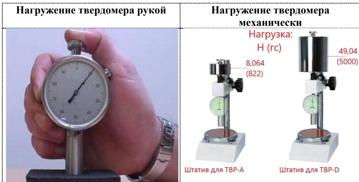
Твердомеры производства Восток-7 универсальны тем, что твердомер ручного типа можно закрепить в инструментальном штативе, преобразовав его в твердомер механического типа. Штатив можно приобрести позднее, если точность и повторяемость результатов измерения рукой не удовлетворяют Вашим требованиям к точности измерений.
