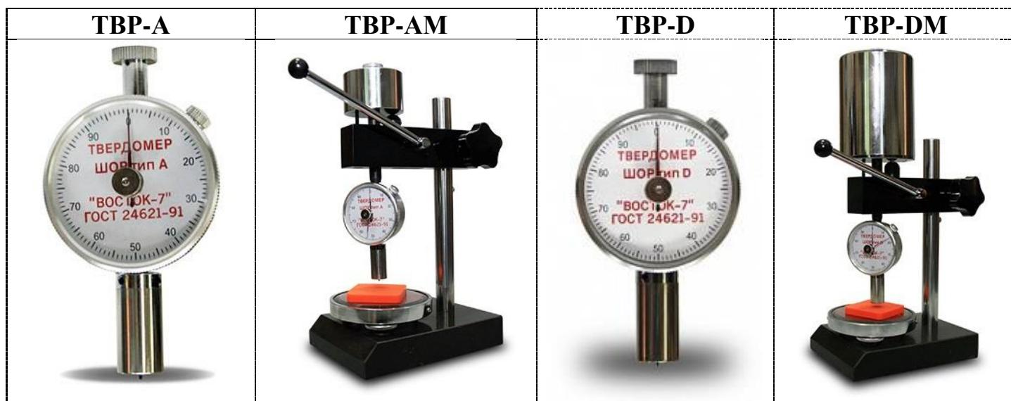
Приборы для измерения твёрдости материалов по Шору А и D (дюрометры) модификаций TBP-A, TBP-AM, TBP-D, TBP-DM являются средствами измерений, зарегистрированными в Государственных реестрах СИ России под № 59928-15 и Республики Казахстан под № KZ.02.03.07058-2016/59928-15, методика поверки МП 59928-15, интервал между поверками 1 (один) год.
